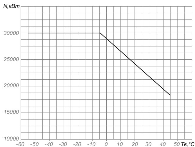
Ограничение мощности ГТД ДУ80Л1 в зависимости от температуры воздуха на входе в двигатель
