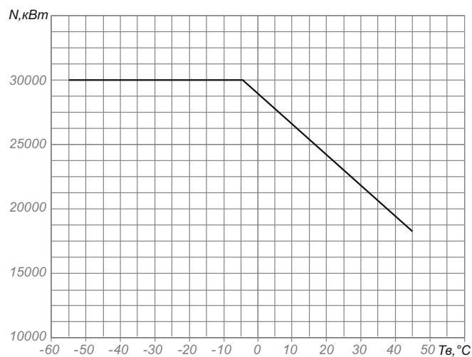
Ограничение мощности ГТД ДУ80Л в зависимости от температуры воздуха на входе в двигатель
