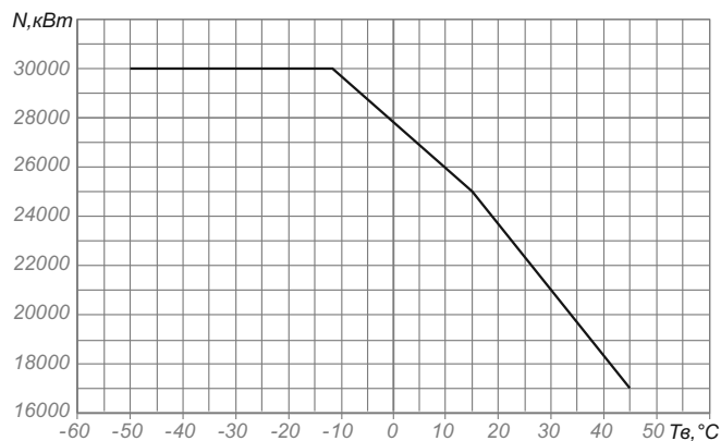
Ограничение мощности НК-36СТ в зависимости от температуры воздуха на входе в двигатель
